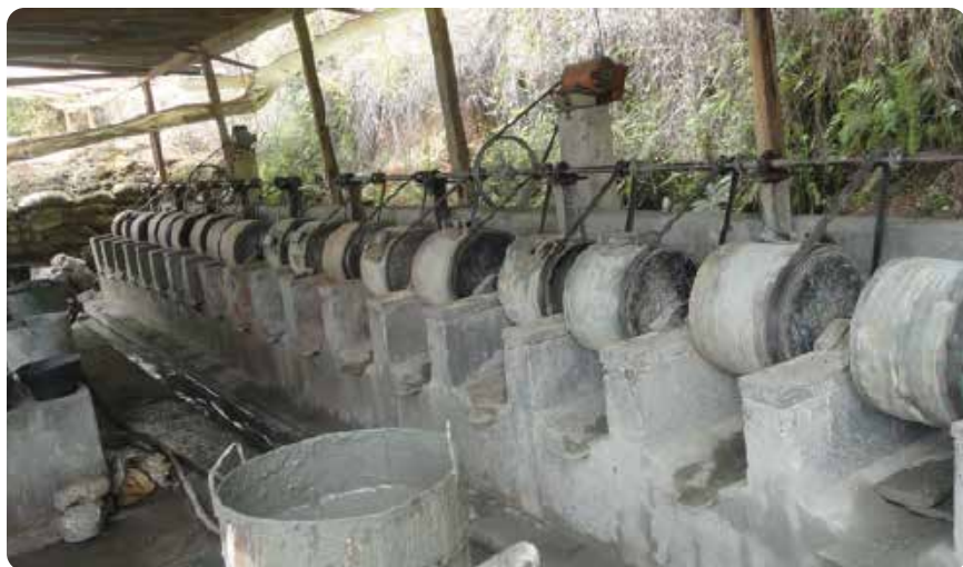
Figura 11. Molienda de bolas en la región de Íquira conocida como 'cocos'. Fuente: Servicio Geológico Colombiano
